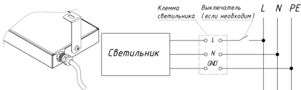
Рисунок 5. Схема подключения светильника.
